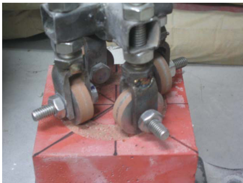
รูป 3.1 แสดงล้อหมุนที่ใช้ทดสอบการสึกหรอของคอนกรีต
